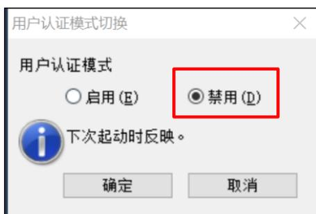
⑦ 点击【确定】后重启 GX Works3 软件，则能进入以往读写程序的操作流程。
