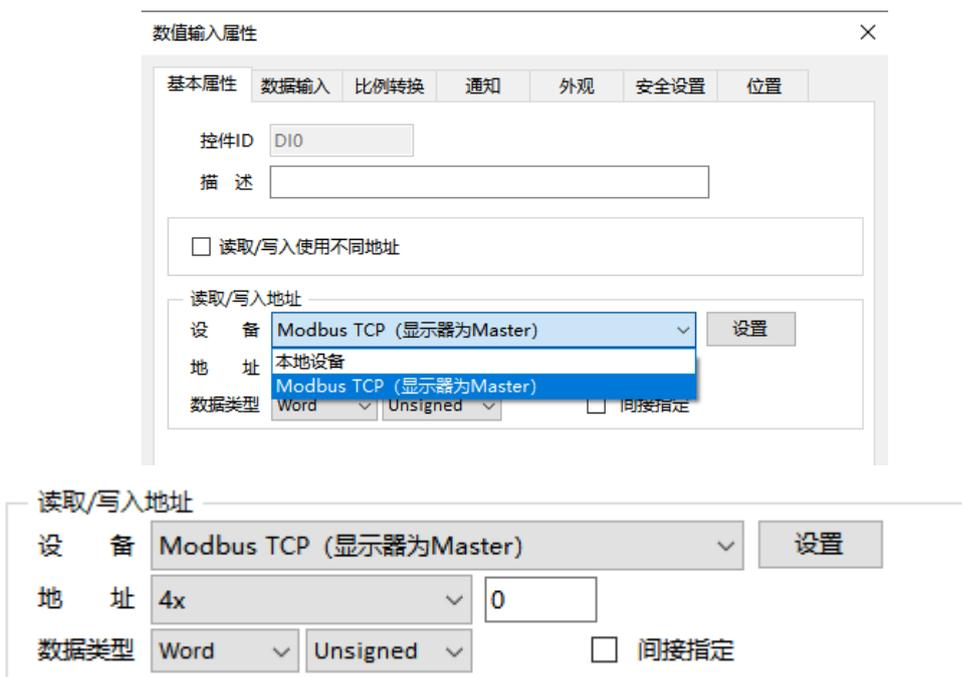
(8) 程序编好后，下载到屏中即可实现触摸屏通过以太网控制 PLC 等 Modbus Tcp 通讯设备。
