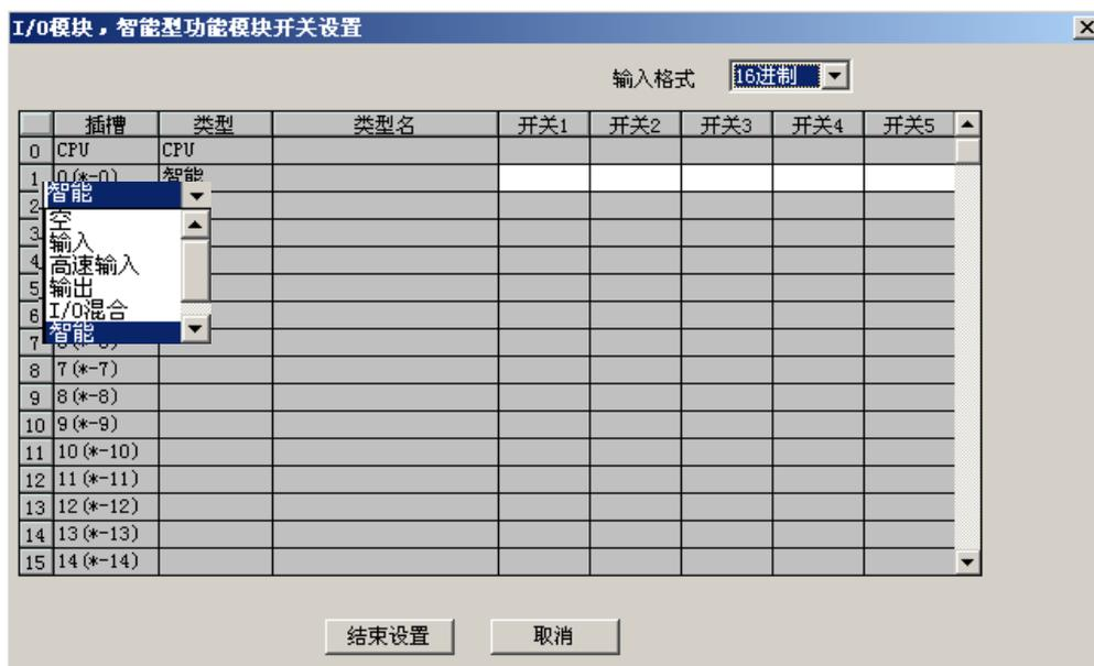
⑤ 设置类型为“智能”这一行参数：在“开关1”输入“07E6”，“开关2”输入“0005”，“开关5”输入“0000”，就可以了：
